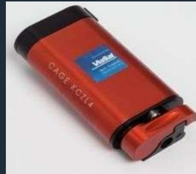
Unidad portátil de almacenamiento de llaves (PKSU) (Alimentada por batería)
